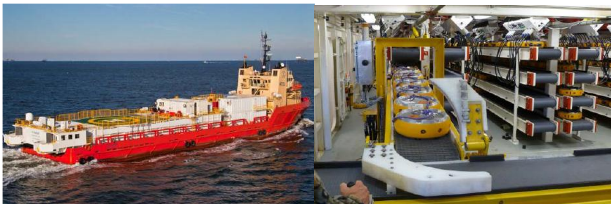
Рис. 4. Специализированное судно-раскладчик для модулей Z700 (слева), Прокаточная лента для подачи модулей Z700 (справа) [3].
